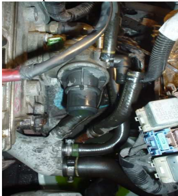
Temperatuursensor eruit draaien (let op kopere ringetje)
