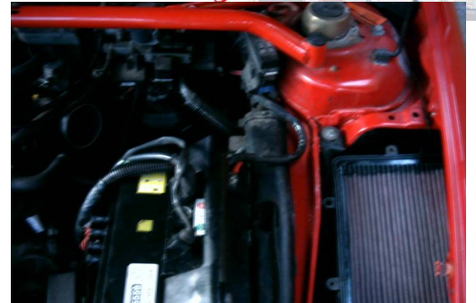
Schoon K&N filter zichtbaar.
