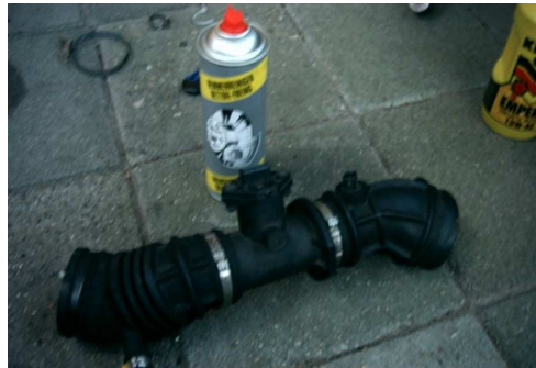
Luchtslang + afdekkap luchtfilterhuis gedemonteerd.
