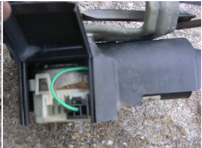
het relais, de motor moet nog van het mechanisme, plastic kap eraf, kapje van sleeprelais eraf en dan opschuren. En een klein beetje vet op de beweegbare delen van de motor smeren
