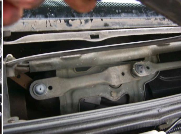
maak het ruitenwissermechanisme los dmv 2x boutje en 2x schroefje los te draaien
