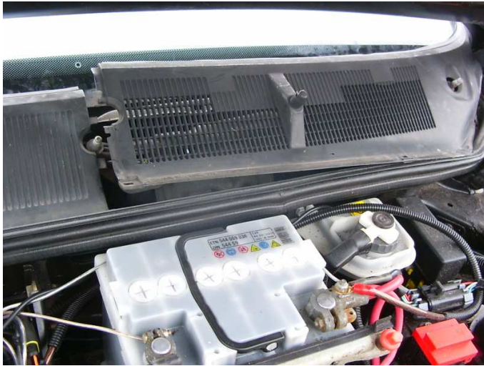
verwijder de afdekplaat, maak de sproeislangetjes eronder los
