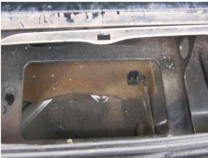
dan achter het motortje nog even het stekkertje loshalen
